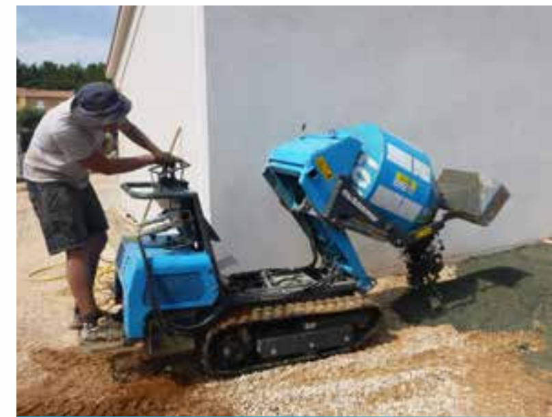
Versione con betoniera, capacità di resa 180 l Versione bétonnière, 180 l de béton rendu
